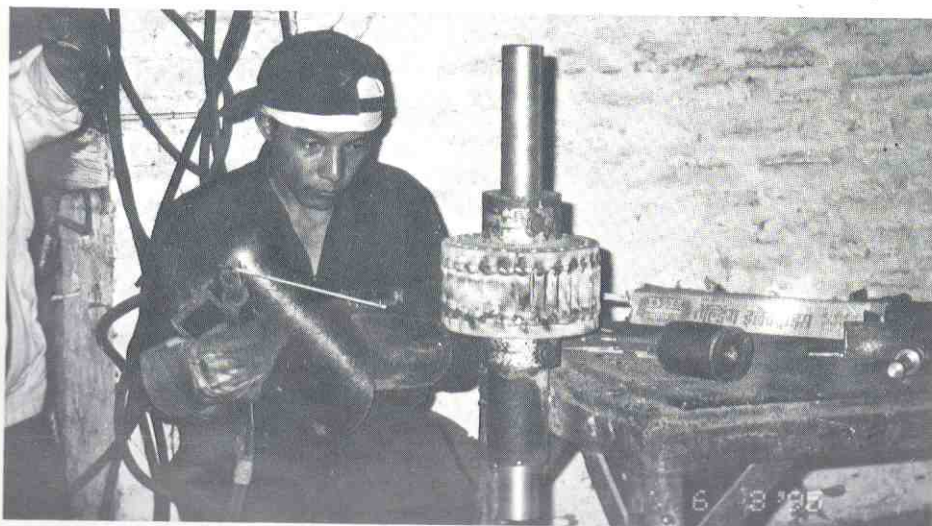
Haciendo una turbina de flujo transversal en Butwal (Sanjeevani Munasinghe/IT).
