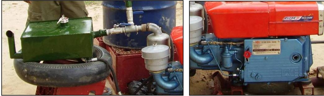
*Tanque de aceite combustible y adaptación de cañería para ingreso de combustible al motor diesel.*
