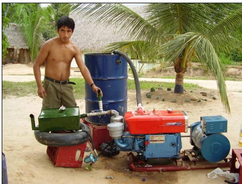
*Funcionamiento del generador eléctrico utilizando aceite vegetal combustible.*
